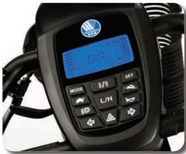
Digitale Anzeige- LCD mit USB- Verbindungsstück
