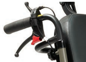
B74 - Kompatibel mit Bremsen für begleitende Person
