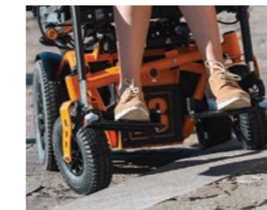
Dank der Pendelachse hat der Forest 3 immer Bodenkontakt, auch wenn es sich um unebenes Gelände handelt
