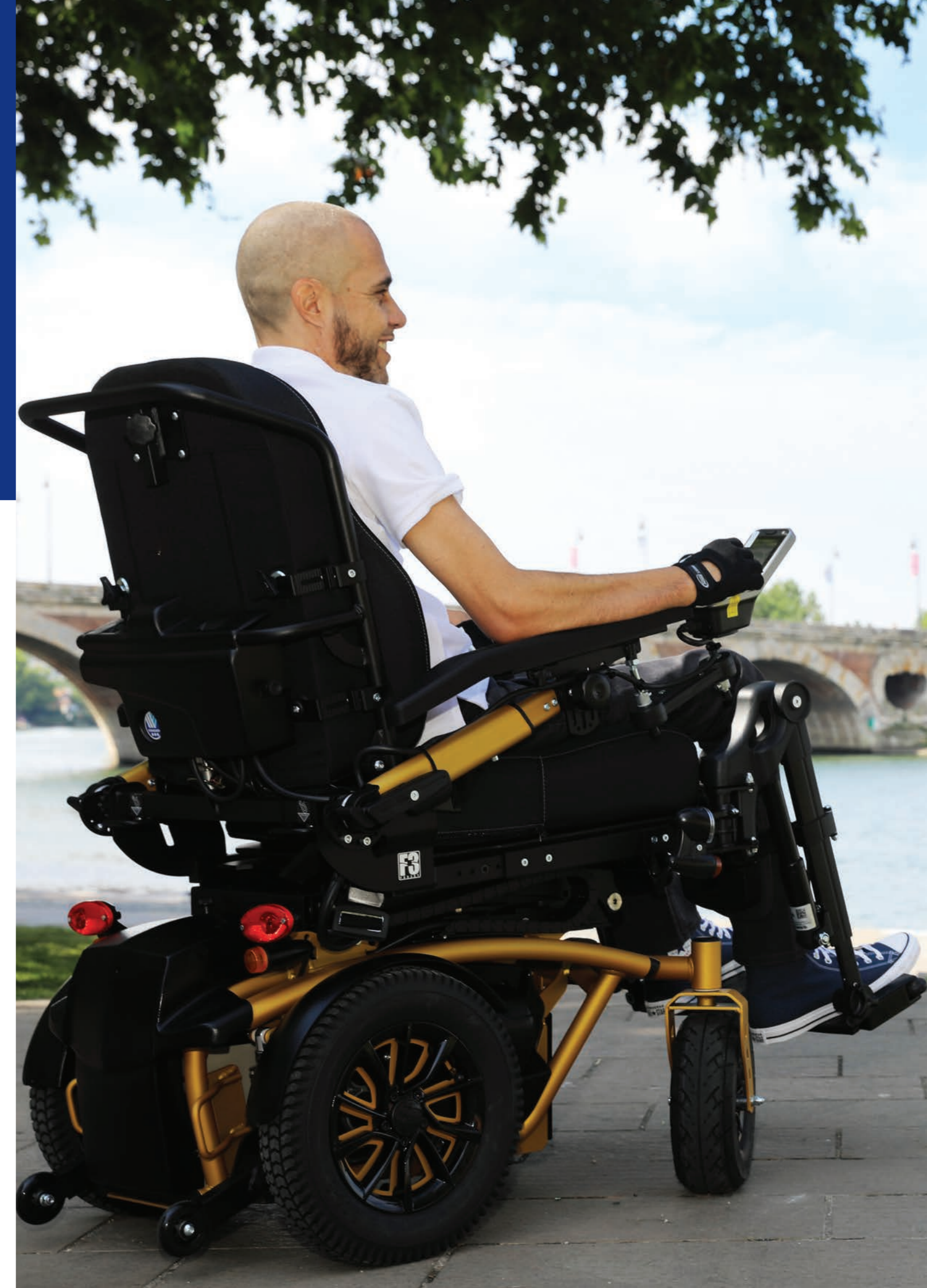
Dank der Pendelachse hat der Forest 3 immer Bodenkontakt, auch wenn es sich um unebenes Gelände handelt
