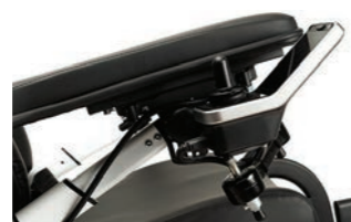
S53Z abklappbare Steuerung
