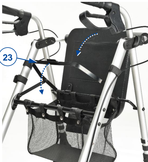
Abbildung 8: Auffalten des Rollators
